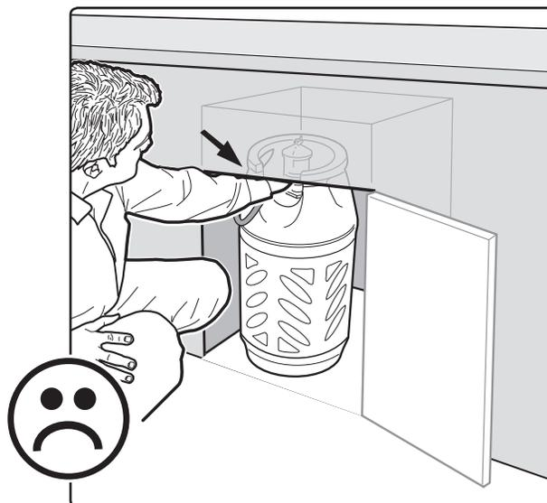
Установите держатель баллона сверху встроенного бака, используя нержавеющие крепежные детали. **КРЕПЕЖНЫЕ ДЕТАЛИ ДЛЯ УСТАНОВКИ НЕ ВКЛЮЧЕНЫ В КОМПЛЕКТ.** ♦
